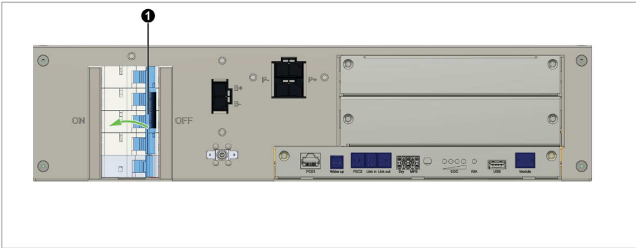
Abb. 3: HV- Box einschalten
